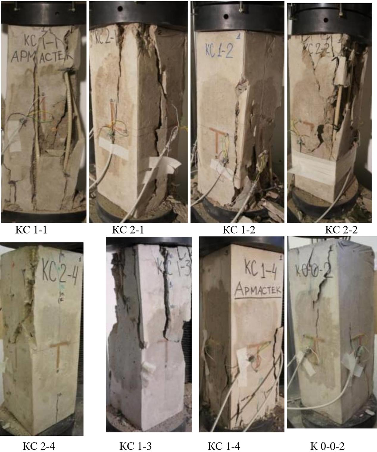
Рисунок 3.13 – Схема развития трещин и характер разрушения образцов 1-й серии, – армированных АСК
