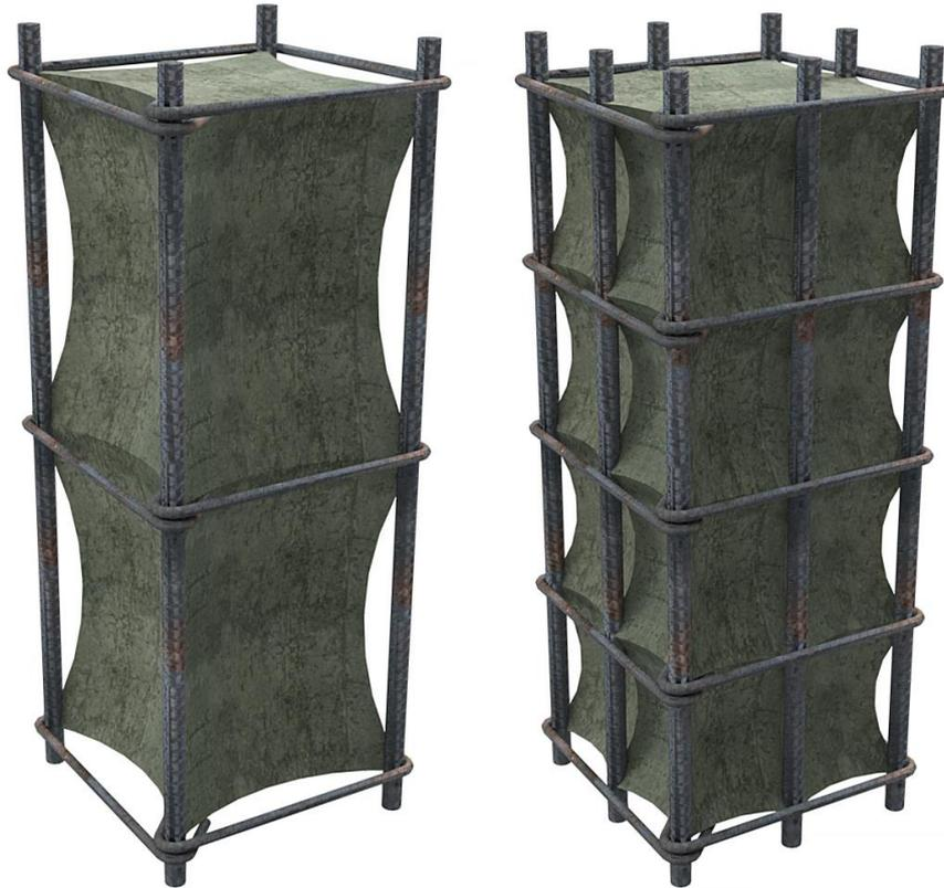
Рисунок 2.7 – Визуализация эффективно ограниченного бетона при обычном (слева) и учащенном (справа) шаге поперечной арматуры
