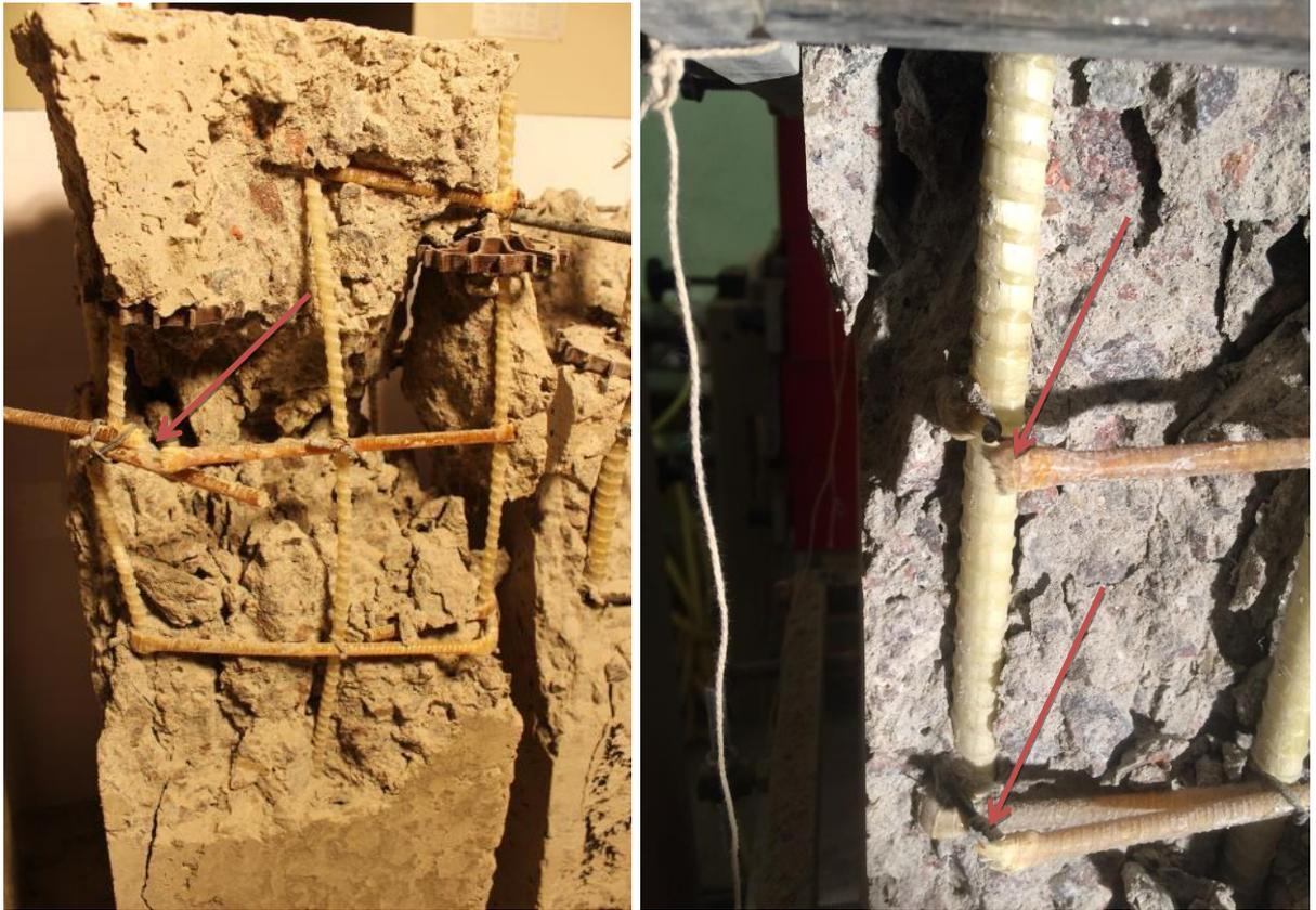
Рисунок 3.18 – Разрыв поперечной стеклокомпозитной арматуры (хомутов)
