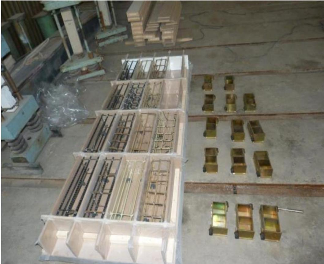
Рисунок 3.2 – Кассета для изготовления образцов 1-й серии
