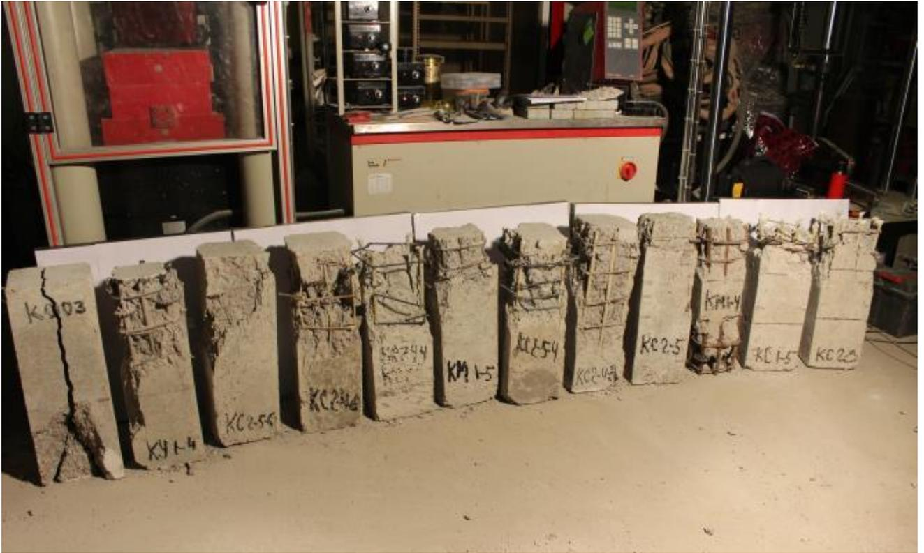
Рисунок 3.14 – Схема развития трещин и характер разрушения образцов 2-й серии
