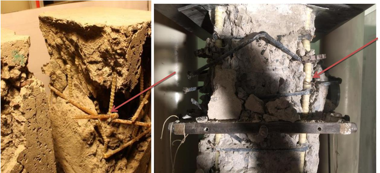
Рисунок 3.16 – Потеря устойчивости стержней продольной арматуры
