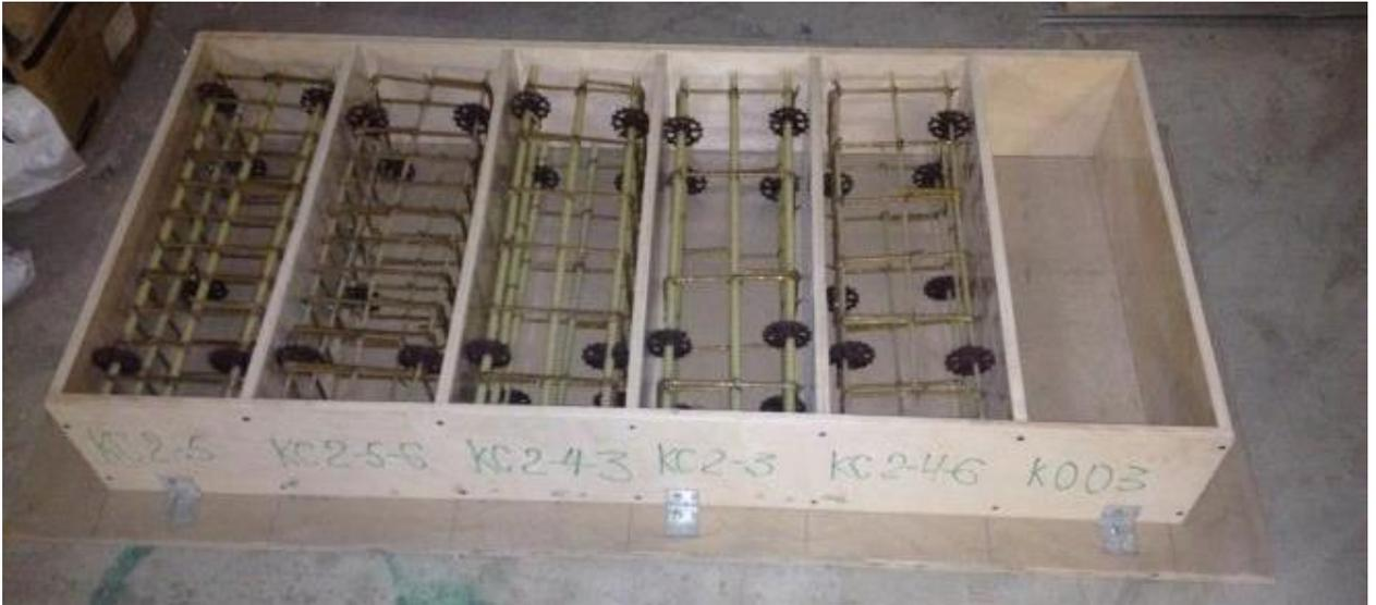
Рисунок 3.4 – Арматурные каркасы образцов 2-й серии в кассете перед бетонированием
