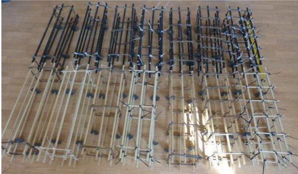
Рисунок 3.1 – Арматурные каркасы образцов 1-й серии
