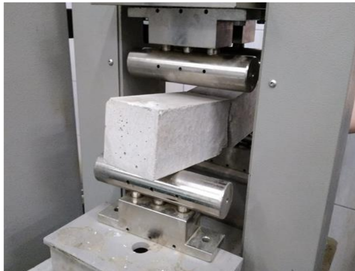
Рисунок 4.4 – Нагружение образца-призмы до разрушения
