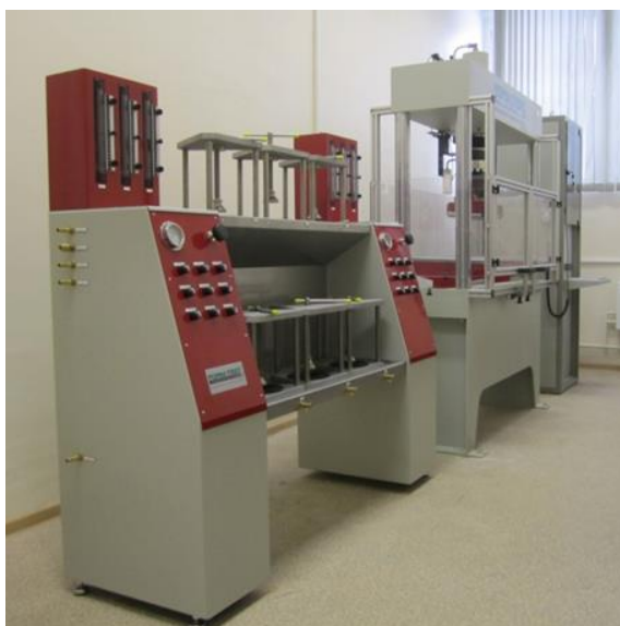
Рисунок 2.8 – Установка для определения водонепроницаемости бетонных
