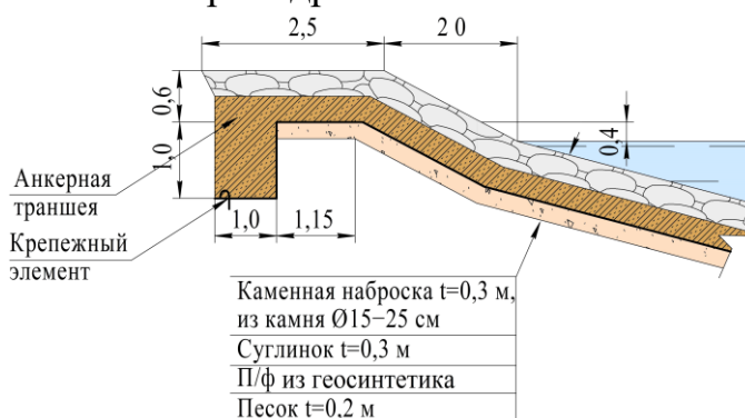
Рисунок 16 – Облицованный участок обследуемого канала и конструкция противофильтрационного экрана
