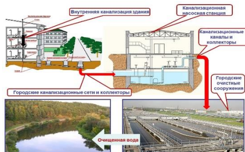
Рис.1. Принципиальная схема системы водоотведения Москвы
