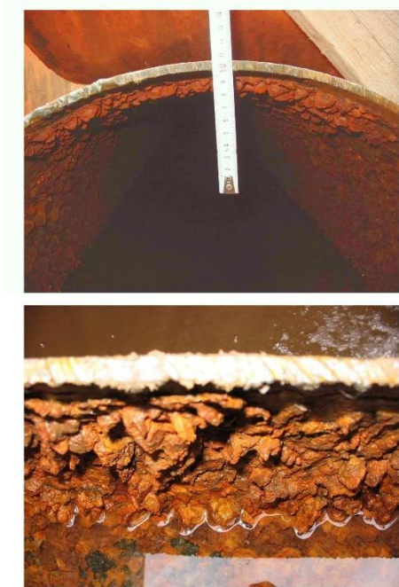
Рисунок 2. Фактическая толщина слоя отложений на внутренних стенках металлических труб
