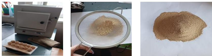
Рисунок 3. Образцы обожженного осадка ВОС г. Севастополь: а) – готовые образцы после обжига в муфельной печи б) – процесс сеева измельченного обожженного осадка; в) – подготовленный обожженный осадок для дальнейшего исследования
