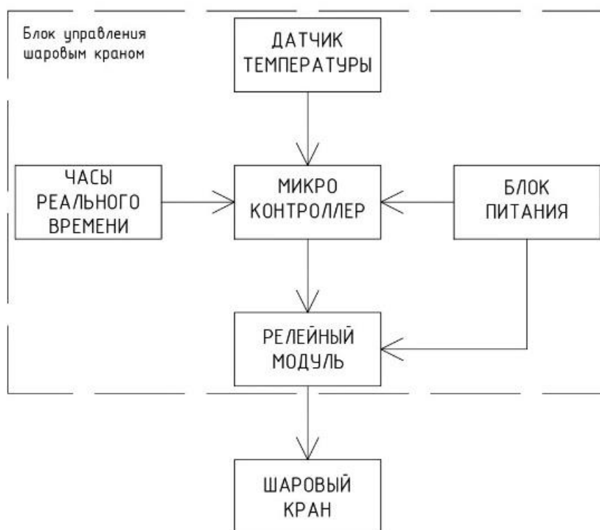
Рис. 2. Структурная схема управления шаровым краном
