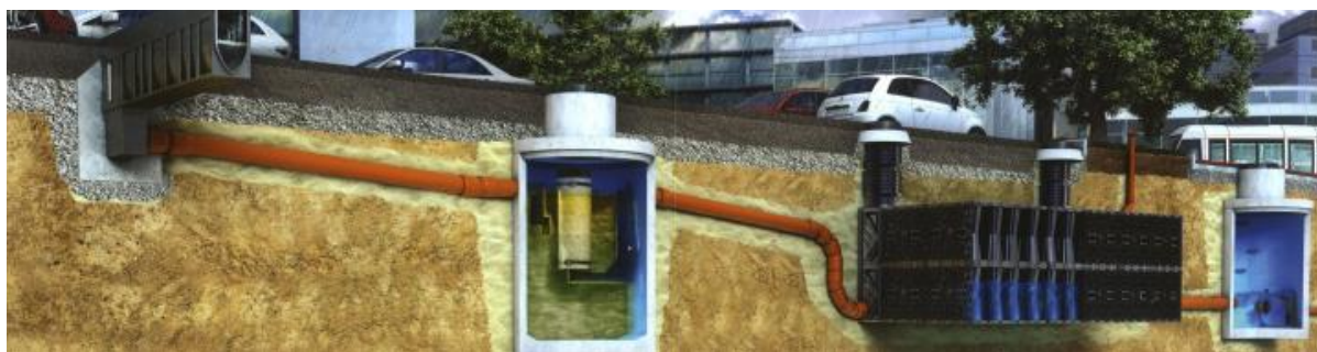
Рис.4. Схема сбора атмосферной воды в городе [12]
