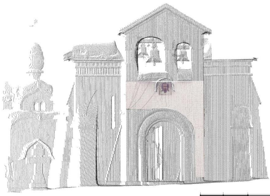
Рис. 1. Церковь Спаса Нерукотворного Музея-заповедника Абрамцево, западный фасад. Вид облака точек в программе AutoCAD 2016.
