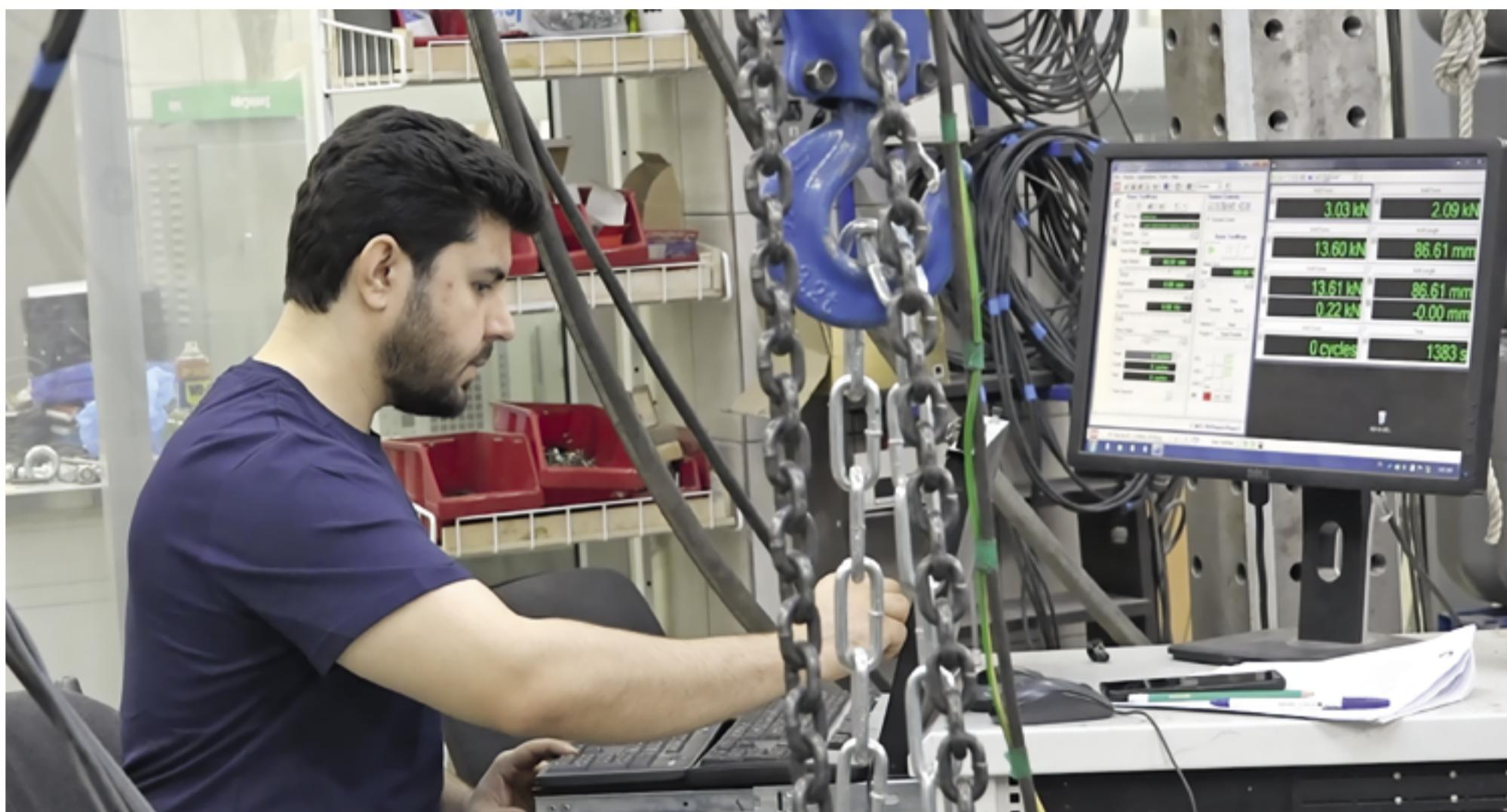
**И**спытания позволяют получить данные о работе соединительных элементов и pontонов под нагрузкой. Результаты исследования будут использованы для создания математической модели наплавных сооружений: причалов, пирсов и мостов.
