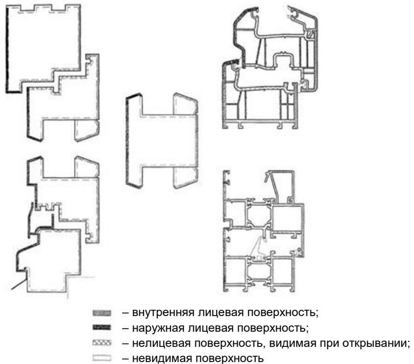
Рисунок 9 – Пример определения видов поверхности деталей изделий
