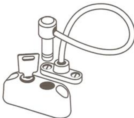
Рисунок Г.7 – Детский замок безопасности с функцией блокировки поворота створки в виде гибкого троса
