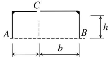
Для составной конструкции  $ACB$  определить реакции опор  $A$ ,  $B$ , а также усилия в сочленении  $C$ , возникающие под действием заданной нагрузки.
