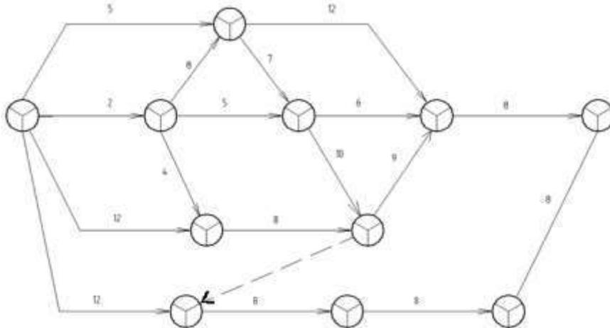
25. Построить сетевую модель, используя коды работ. Рассчитать секторным методом сетевой график при заданных кодах работ и их продолжительностях. Показать общие и частные резервы и работы, лежащие на критическом пути.
