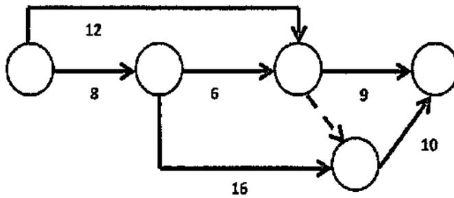
6. Определить продолжительность строительства объекта по сетевому графику
